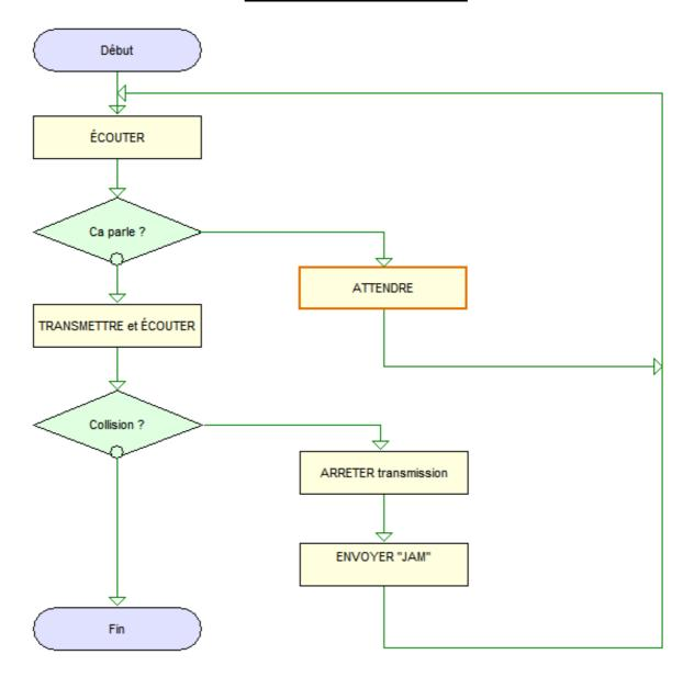
La méthode d'accès se base sur la couche physique du modèle OSI (niveau 1), détermine comment les stations peuvent émettre sur le câble. Deux méthodes principales sont utilisées: la contention et le jeton. Les réseaux Ethernet utilise la contention (CSMA/CD), le token Ring utilise le jeton, chacun a le droit de communiquer à son tour. Les deux méthodes sont normalisées par l'IEEE : 802.3 pour Ethernet et 802.5 pour l'anneau à jeton.
